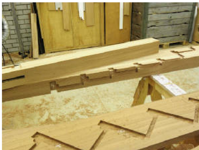
Figuur 11 — Voorbeeld van inkrozing (Bron: Van Schijndel)
